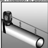
Ligne de référence pour l'installation de tuyaux
