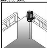
Ligne de référence pour les cloisons verticales
